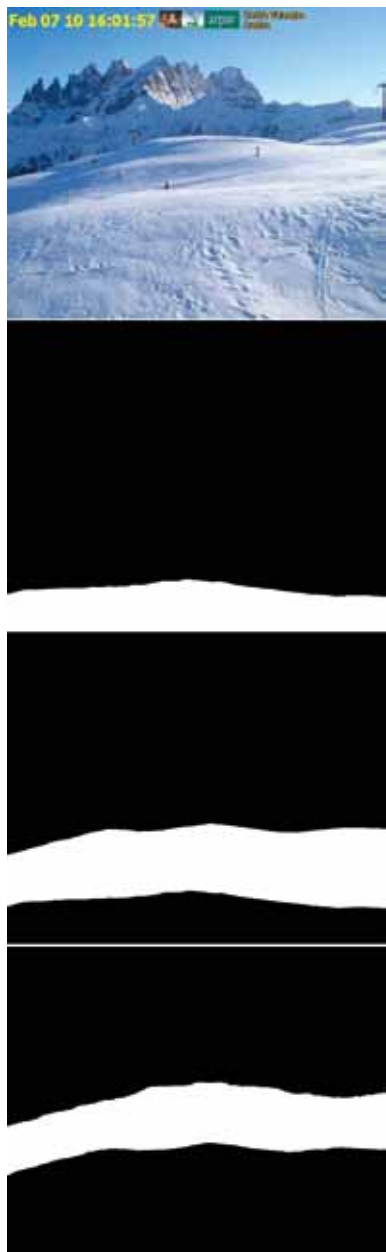
Fig. 13 - Il software permette l'analisi contemporanea di più parti dell'immagine. In alto l'immagine originaria, e in basso le 3 maschere che corrispondono a 3 aree di superficie nota. Le maschere sono individuate dal software e l'analisi dei pixel avviene nell'area bianca.
